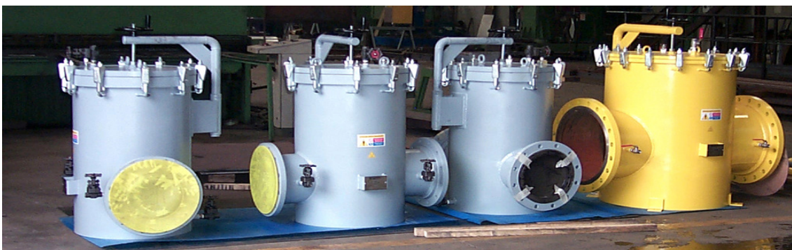
Filtri a Cestello per alte portate di condensato e acqua alimento. (Centrale termoelettrica). Grado di filtrazione 400 \mu con inserti da 200 \mu . Basket filters for condensate and feed water (Power generation) filtration rating 400 \mu with insert of 200 \mu
